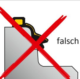
2. Schachtring zentrisch und gerade hängend aufsetzen und aufgleiten lassen.
